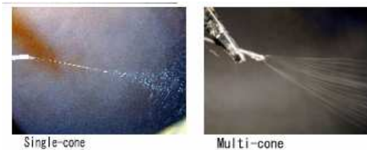
شکل ۹: انواع نازل‌های تولید کننده شبکه الیاف در دستگاه الکترواسپینینگ
