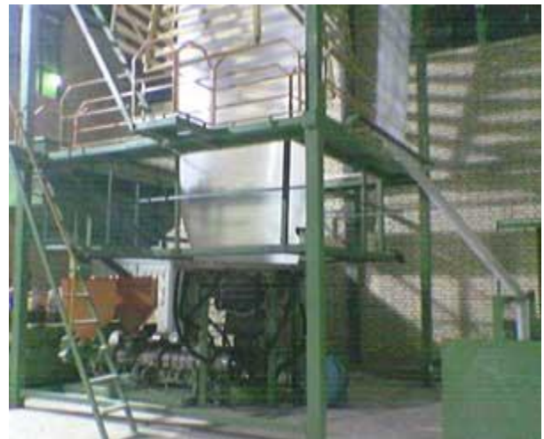
شکل ۳-۱- دستگاه تولید نایلون حباب دار
