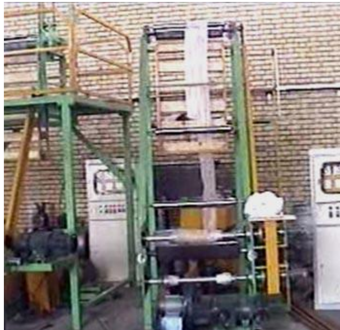
شکل ۳-۲- دستگاه تولید نایلکس
