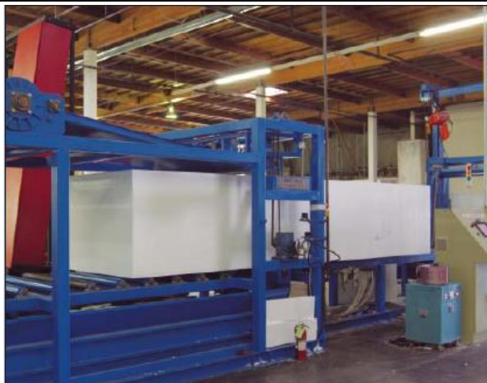
شکل ۲-۱۰- فوم خارج شده از قالب بر روی تسمه نقاله
