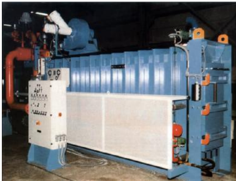
شکل ۲-۹- قالب بلوکی پلی استایرن انبساطی
