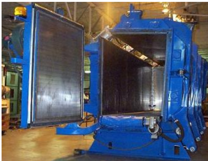
شکل ۲-۷- نمونه ای از قالبهای بلوکی
