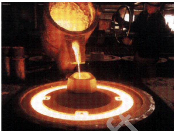
شکل ۱: بارریزی فلز در قالب
