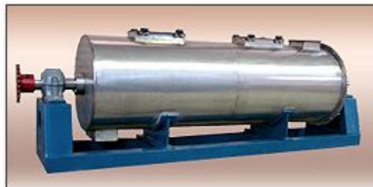
خمیرگیر: برای تهیه خمیر در خط تولید نشاسته گندم
