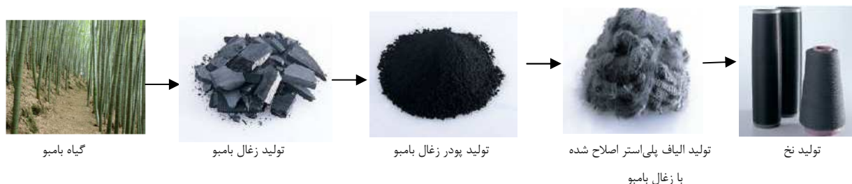
شکل (۱) - مراحل تولید نخ حاصل از الیاف پلی استر اصلاح شده با زغال بامبو
