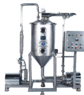
یک نمونه ماشین ساخته شده از ورق استنلس استیل
