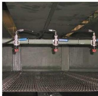
در این روش تولید که Foam bonding یا Spray bonding می‌باشد لایه الیاف با آغشته شدن به مواد شیمیایی و مواد تکمیلی دیگر و پس از عبور از خشک کن یا پخت مستحکم می‌گردد.
