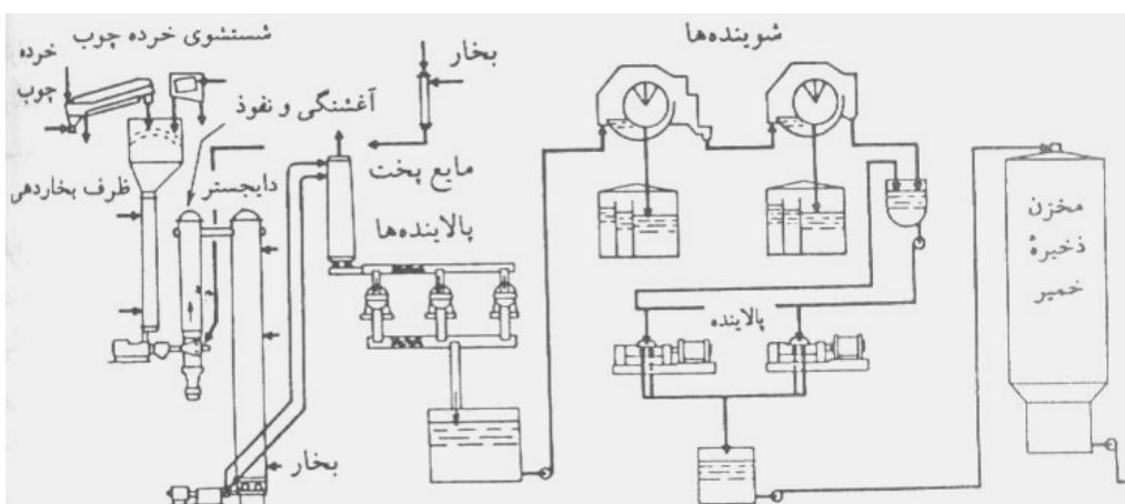
شکل ۴-۶. نمودار یک کارخانه خمیرسازی نیمه‌شیمیایی مدرن که با استفاده از پخت پیوسته عمل می‌کند.
