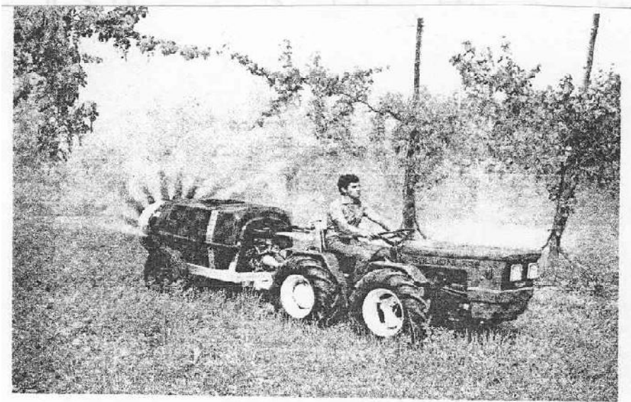
شکل شماره 6- تراکتور باغچه ای چهارچرخ محرک کمرشکن در حال سمپاشی درختان میوه
