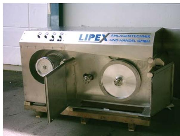
شکل ۲۱-۳) شمای کلی از دستگاه چاپینگ
