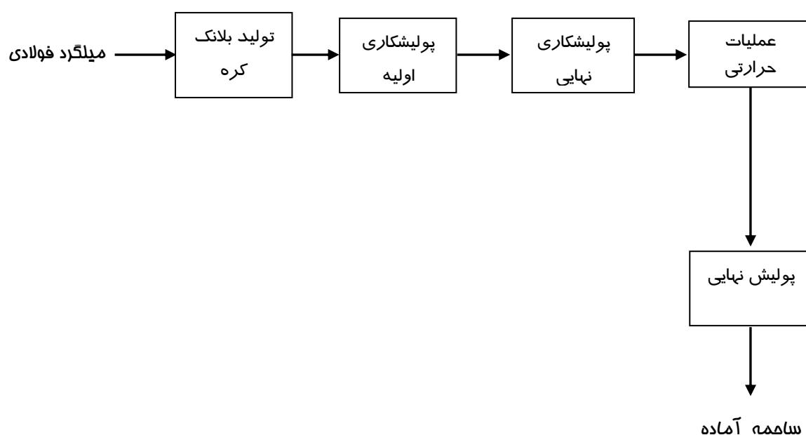
مرحله نخست در تولید ساچمه ها، شکل دهی سرد یا گرم است (cold or hot forming operation). شکل دهی سرد یا گرم است (cold or hot forming operation). مفتولی از فلز به قطر تقریبی ساچمه مورد نظر وارد دستگاه کله زنی ویژه ای (heading machine) شده که در هر طرف خود یک حفره نیمکروی دارد. در یک ضربه ناگهانی - چیزی شبیه آهنگری یا فورج - قطعه ای از این مفتول جدا شده و به صورت یک کره پلیسه دار در می آید ( مانند حلقه ای که سیاره کیوان را احاطه کرده است )
