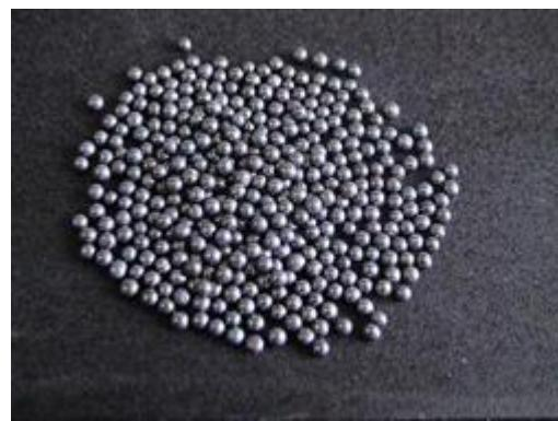
ساچمه های شات بلاست در اندازه های مختلف تولید و به بازار عرضه می گردند . اندازه دانه های شات بلاست تابع نوع و ابعاد موارد کاربرد دانه ها در عملیات شات بلاست می باشد . لذا در حالت کلی باید گفته که ساچمه های فولادی شات بلاست از سایز دو دهم میلیمتر الی سه میلیمتر تولید و به بازار عرضه می گردند .
