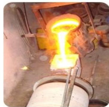
ریخته گری گریز از مرکز ( Centrifugal Casting ) یکی از انواع روشهای ریخته گری است که عموماً برای تولید قطعات سیلندری شکل و قطعات متقارن استفاده می شود . در این روش ابتدا فلز مذاب در اثر دوران به جداره قالب فرستاده می شود، سپس قالب حول محور خود حرکت می کند (حرکت عمودی یا افقی ) و فلز با فشار وارد می شود تا بعد از برخورد و چرخش به شکل مورد نظر استوانه ای در آید . سرعت چرخش قالب بین ۳۰۰ تا ۳۰۰۰ دور در دقیقه باشد.
