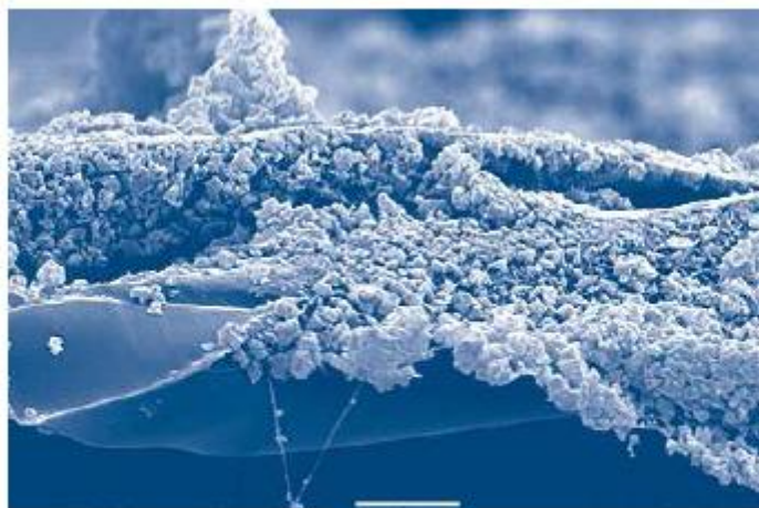
نانو فیلتر مورد استفاده در کولر جهت تصفیه هوا و ذرات گرد و غبار جمع شده در پشت آن.
