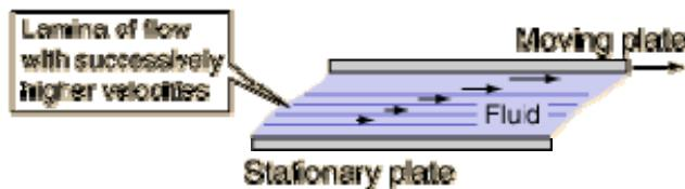
بدین ترتیب یک گرادیان سرعت بین لایه‌های مختلف سیال وجود دارد و سیال تمایل دارد در لایه‌های با سرعت بیشتر جابجا گردد که به آن اصطلاحاً جریان لامینار گویند. تحت جریان لامینار، نیروی لازم برای جابجایی یک سطح در سرعت ثابت نسبت به مقاوت یک سیال متناسب با مساحت سطح و گرادیان سرعت در راستای عمود بر سطح است. ثابت تناسب گرانزوی نام دارد.
