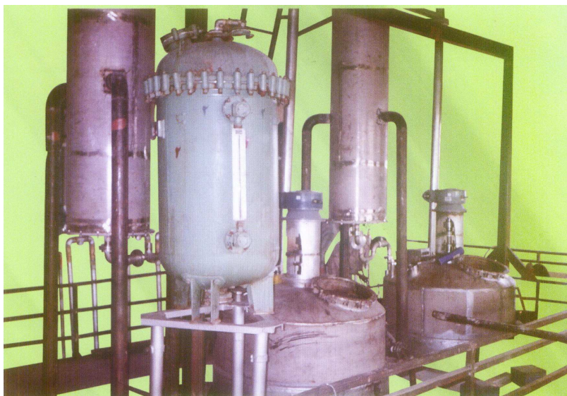
شکل ۳: نمایی از راکتورهای مورد استفاده در تولید کود سوپر فسفات
