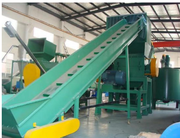
شکل ۱، نوار نقاله برای انتقال ضایعات به دستگاه شستشو
