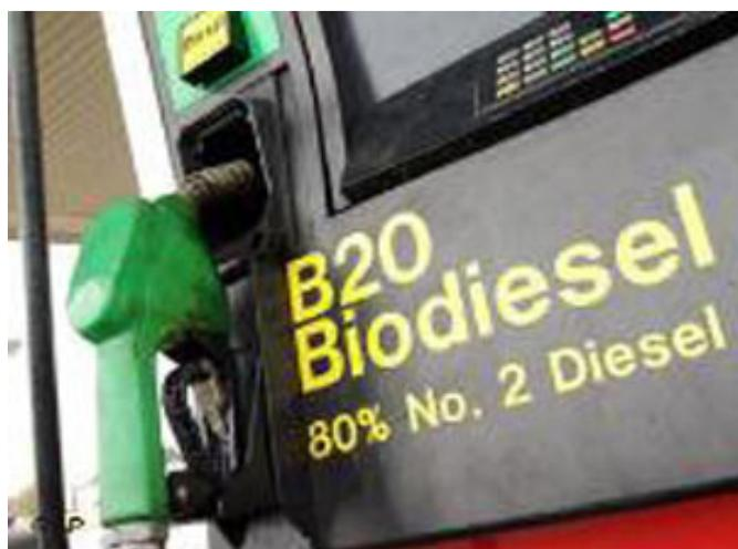
دیزلزیستی می‌تواند به شکل خالص آن B100 یا هر قدار مخلوط با دیزل پالایشگاهی در موتورهای جدید بکار رود. بیودیزل خواص حل‌کننده‌گی متفاوت از دیزل پالایشگاهی دارد، و ممکن است سبب حل شدن بیش از حد طبیعی واشرهای پلاستیکی طبیعی و شلنگهای پلاستیکی در یک کامیون (که اغلب پیش از سال ۱۹۹۲ میلادی ساخته شده‌اند) گردد، که این مشکل در موتورهای امروزی با تعویض آنها برطرف شده است. همچنین بیودیزل سبب پایین ریختن مواد تهذیب شده در مخزن سوخت گردد (که این نیز به سبب قدرت حل کننده‌گی بالای آن است).
