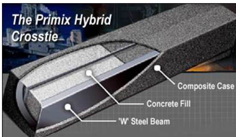
شکل (۲): تراورس کامپوزیتی ساخت شده شرکت primix
