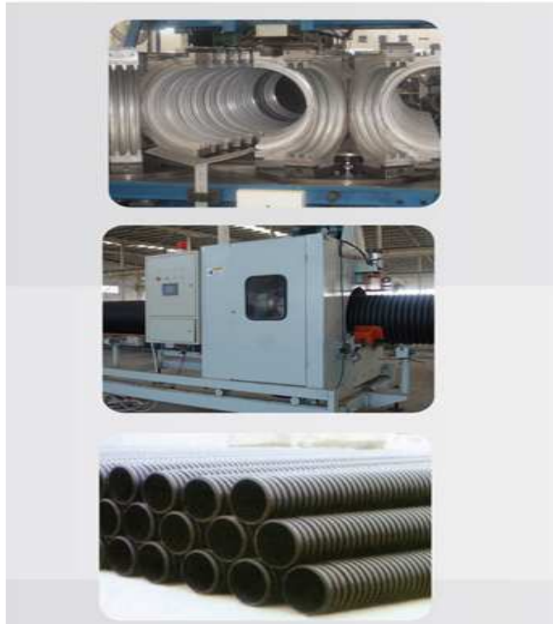
شکل (۱۲): قالبهای کروگیت و فرایند تولید لوله
