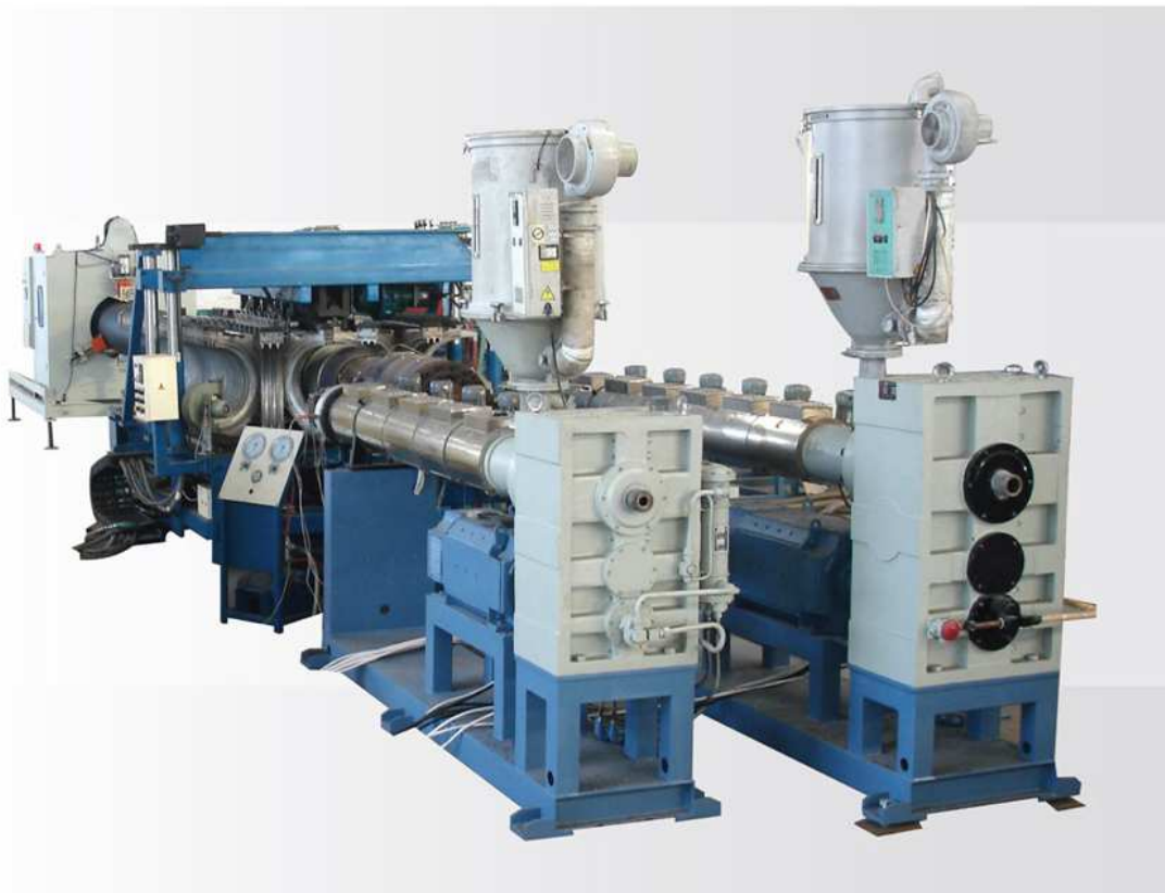
شکل (۱۱): دستگاه اکسترودر تولید لوله پلی اتیلن کروگیت
