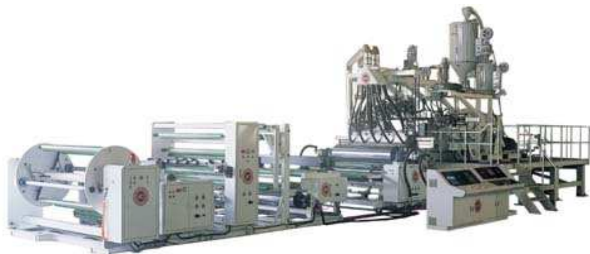
شکل (۲): خط تولید فیلم پلی‌آمید به روش Cast
