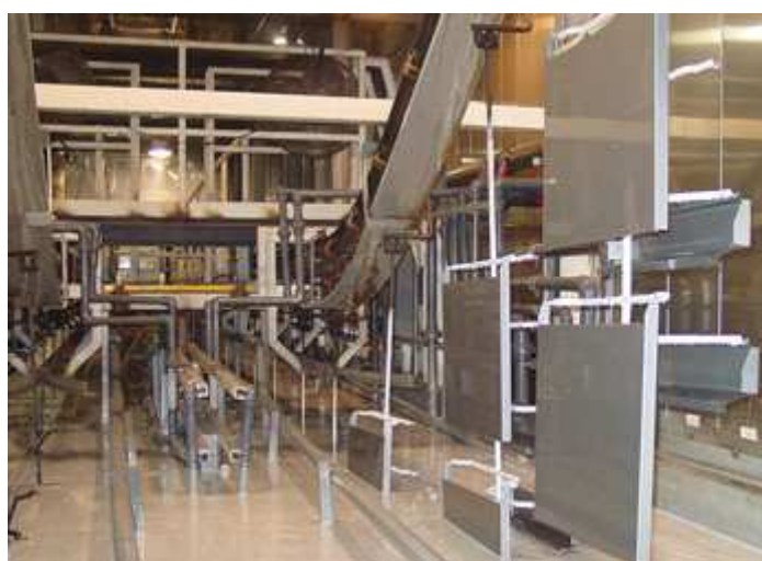
شکل (۳): تصویری از یک خط تولید که در انتها قطعات تولید شده به روش الکتروفورز رنگامیزی می‌شوند
