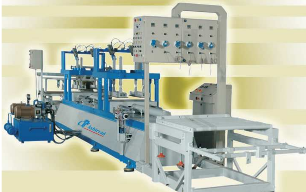
شکل (۸): نمایی از خط تولید پایه کامپوزیتی علائم ایمنی راه به روش پالتروژن
