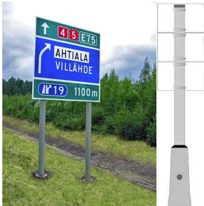
شکل (۶): پایه تابلو از نوع کامپوزیتی
