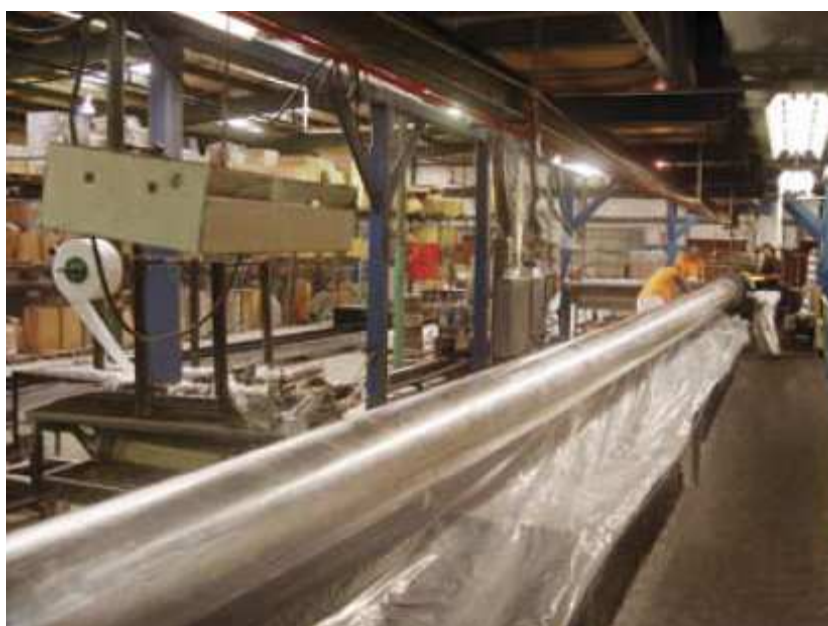
شکل ۱۷- نمایی از خط تولید دکل تلسکوپی کامپوزیتی به روش پالترژن
