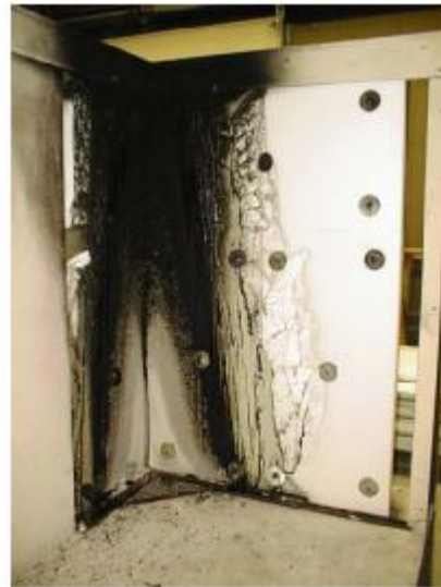
شکل ۱-۱-۱- چگونگی عملکرد فوم پلی استایرن گونه مقاوم در برابر آتش در مجاورت حریق
