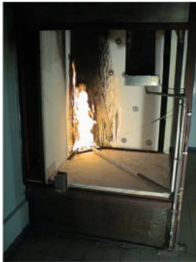
شکل ۱-۱-۱- چگونگی عملکرد فوم پلی استایرن گونه مقاوم در برابر آتش در مجاورت حریق
