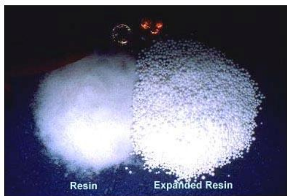
شکل ۲-۱- تفاوت اندازه دانه های رزین و دانه های منبسط شده ( پرپوف)
