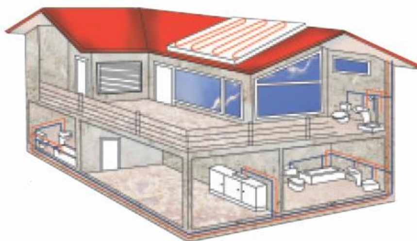
شکل ۱-۵- نمونه ای از استفاده از لوله های سوپر پایپ در لوله کشی منازل
