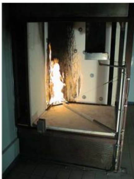
شکل ۱-۱- چگونگی عملکرد فوم پلی استایرن گونه مقاوم در برابر آتش در مجاورت حریق
