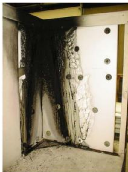
شکل ۱-۱- چگونگی عملکرد فوم پلی استایرن گونه مقاوم در برابر آتش در مجاورت حریق
