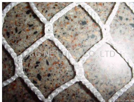
شکل ۴- تور ماهیگیری بدون گره یا راشل
