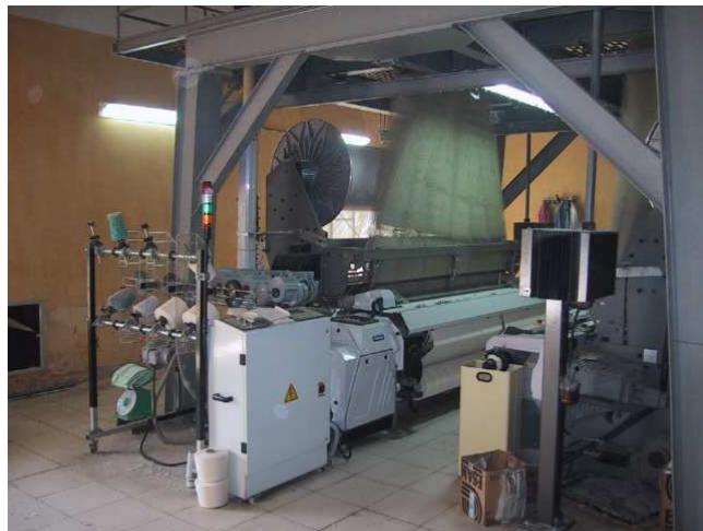
مراحل تولید روفرشی، شامل چله‌پیچی، بافندگی، دور دوزی و بسته‌بندی است. برای این منظور، بوبین‌های نخ پنبه‌ای وارد سالن چله‌پیچی می‌شوند. پس از چله‌پیچی این چله‌ها را پشت ماشین بافندگی قرار می‌دهند. پس از اینکه نخ‌های تار از سیستم‌های کنترل نخ تار عبور دادند، روی غلطک پارچه پیچیده می‌شوند و در این حالت آماده بافت می‌باشند.
