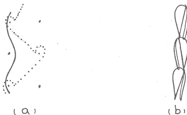
شکل ۱۳- ناحیه توری برای نخ فال‌پلیت (a) حرکت لپینگ (b) وضعیت نخ روی پارچه
