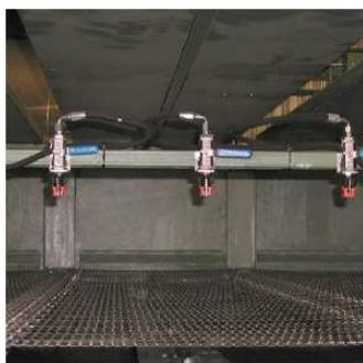
در این روش تولید که Spray bonding یا Foam bonding می‌باشد لایه الیاف با آغشته شدن به مواد شیمیایی و مواد تكمیلی دیگر و پس از عبور از خشک کن یا پخت مستحکم می‌گردد.
