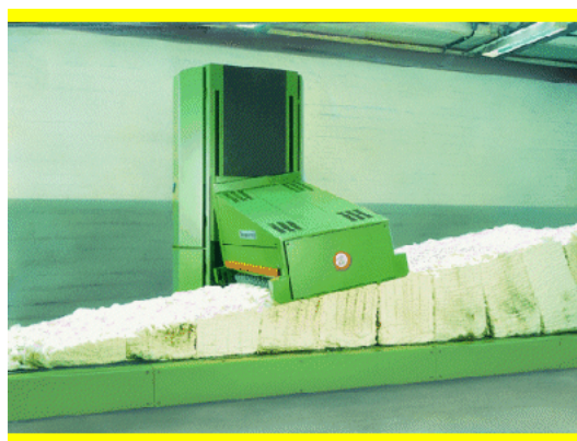
شکل (۲)، نمایی از ماشین بازکننده عدل و چگونگی برداشت الیاف از عدل
