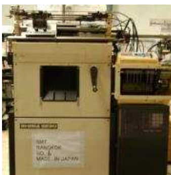
شکل (۵)، نمایی از ماشین اتوماتیک تخت باف دستکش بافی
