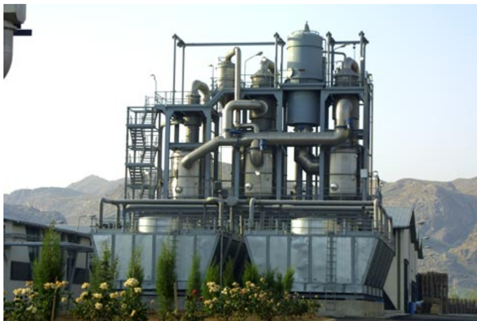
شکل ۴-نمایی از یک سیستم تغلیظ سه مرحله ای تحت خلا
