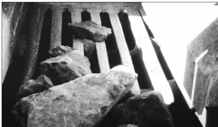
شکل (۱-۳): فرآیند حذف مواد ریزتر از دهانه خروجی سنگ شکن قبل از سنگ شکنی
