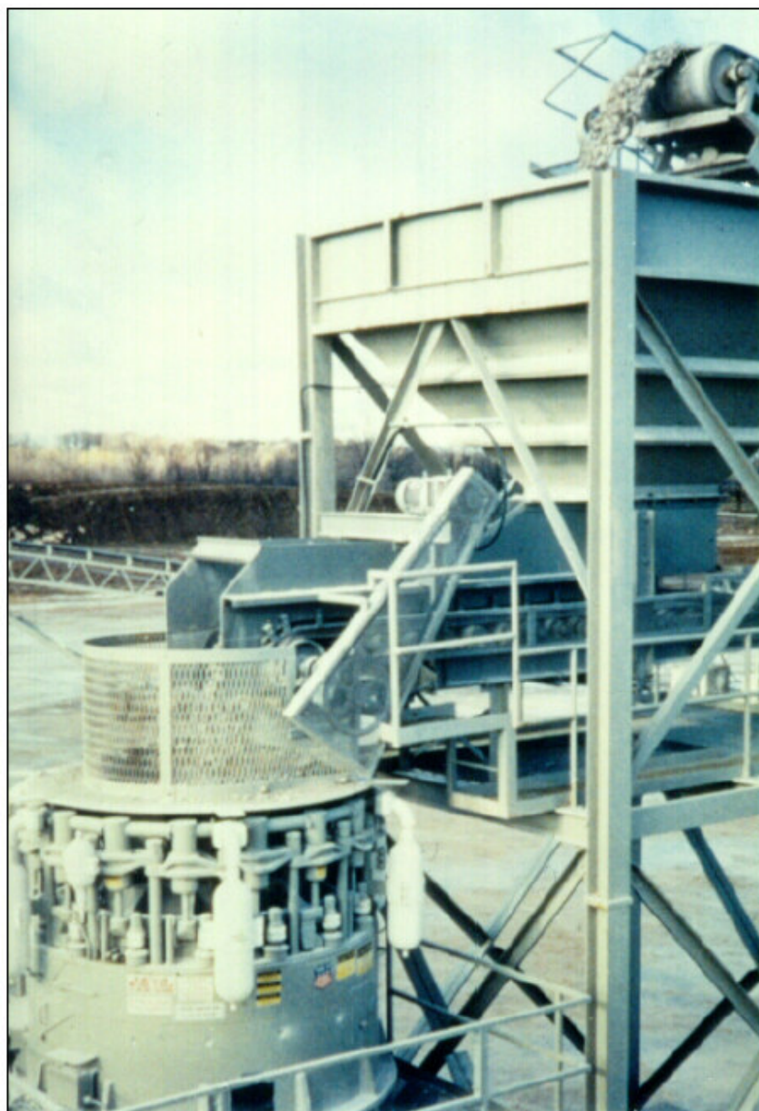
شکل (۱-۵): سیستم خوراک دهی سنگ شکن
