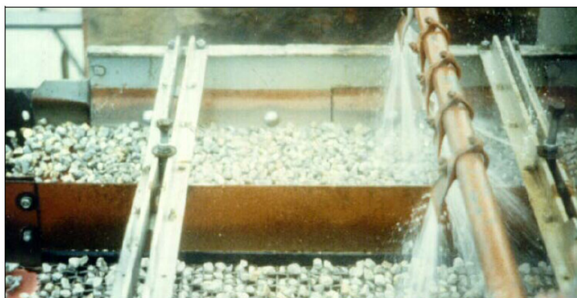
شکل (۱-۶): سرنند تر برای حذف نرمه‌ها و مواد رسی
