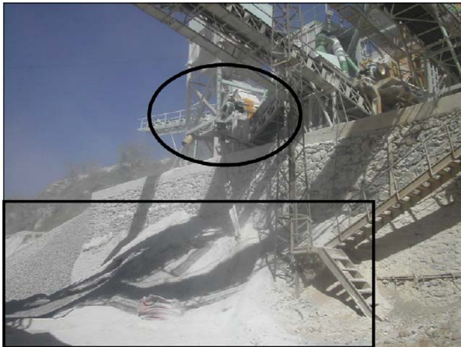
شکل (۵): سیستم جمع آوری و دفع ذرات نرمه و گرد و غبار در فرآوری سنگ آهک
