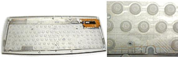
سوئیچ‌های صفحه کلیدهای با تکنولوژی لاستیک برجسته ارزان و مقاوم در مقابل جهش و خورندگی می‌باشند چراکه لایه پلاستیکی ماتریس کلیدها را در بر می‌گیرد. سوئیچ‌های پرده‌ای در عمل شباهت زیادی با سوئیچ‌های پلاستیکی دارند. کلیدهای فوق دارای بخش جدا برای هر کلید نبوده و در عوض از یک ورق پلاستیکی با برآمدگی‌های مربوطه به هر کلید استفاده می‌نمایند. از این نوع صفحه کلیدها برای صنایع سنگین استفاده می‌گردند. از صفحه کلیدهای فوق بnderت در کامپیوتر استفاده می‌گردد.
