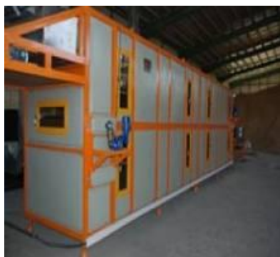
تصاویری از یک سری خشک کن تونلی کابینی مخصوص خشک کردن سبزیجات و صیفی جات
